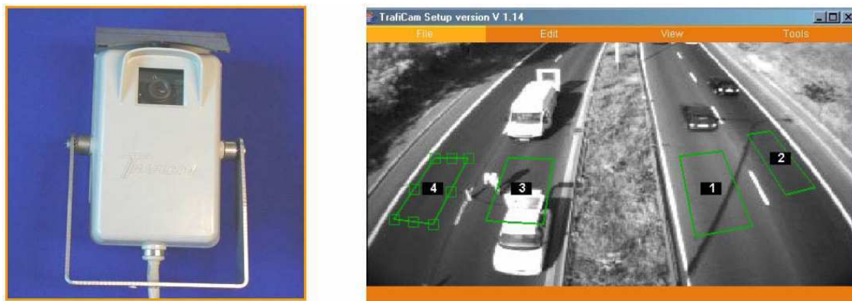
Obr. 3.46 - strategický videodetektor TraficCam a nastavení čtyř virtuálních smyček
